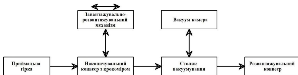
Рис. 1. Схема розміщення конструктивних елементів апарата для вакуумного охолодження хліба в умовах потокового виробництва
