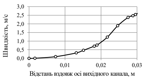
Рис. 6. Зміна швидкостей продукту на виході з дозатора в повздовжньому (а) і поперечному (б) перерізах
