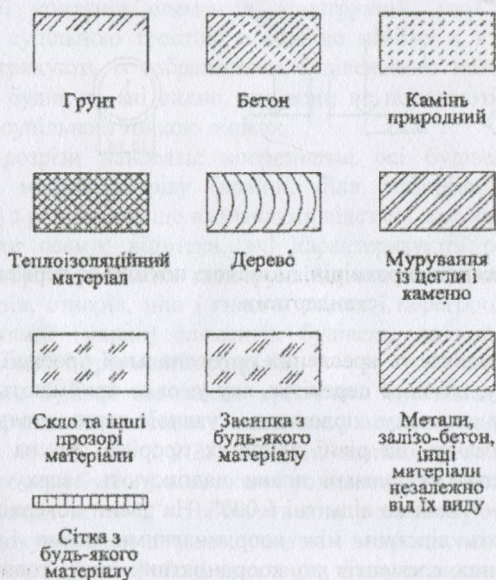
Рис. 4.1. Зображення будівельних матеріалів у перерізі
