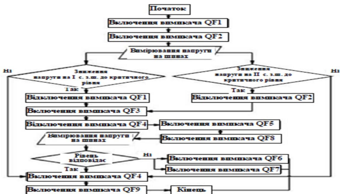
Рис. 3.4 - Алгоритм функціонування електротехнічного комплексу з використанням активного фільтра
