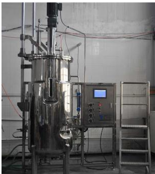
Рис. 4.3 Ферментер для культивування мікроорганізмів BLBЮ-500SJ
