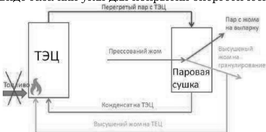
Рис. 10. Схема использования жома как топлива для сахарного завода
