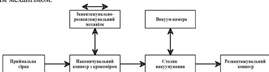
Рис. 10. Схема розміщення ключових конструктивних елементів апарата для вакуумного охолодження хліба в умовах потокового виробництва
