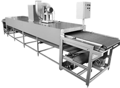
Рис. 3. Охолоджувальний конвеєр КОХ-2 для охолодження хлібобулочних виробів з використанням кондиціонованого повітря
