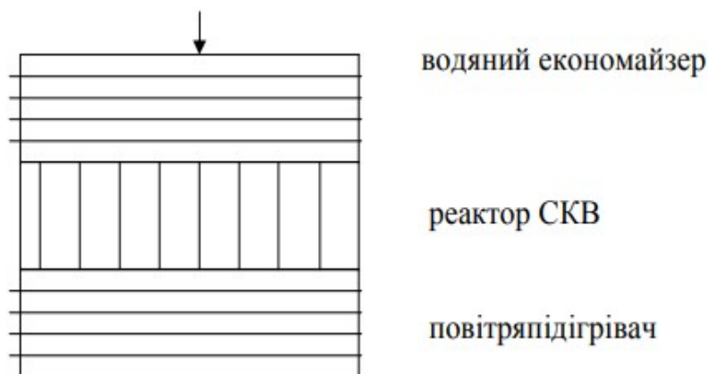
Рис.2. Схема розташування реактора СКВ
