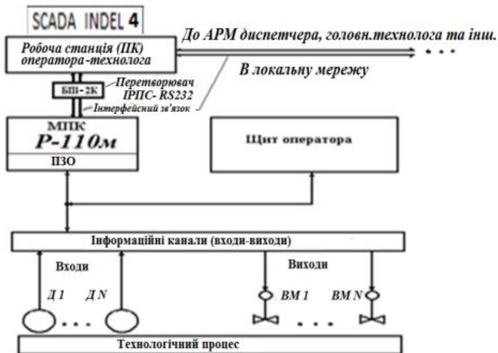
Рис. 1.8 Структура АРМ оператора випарної установки
