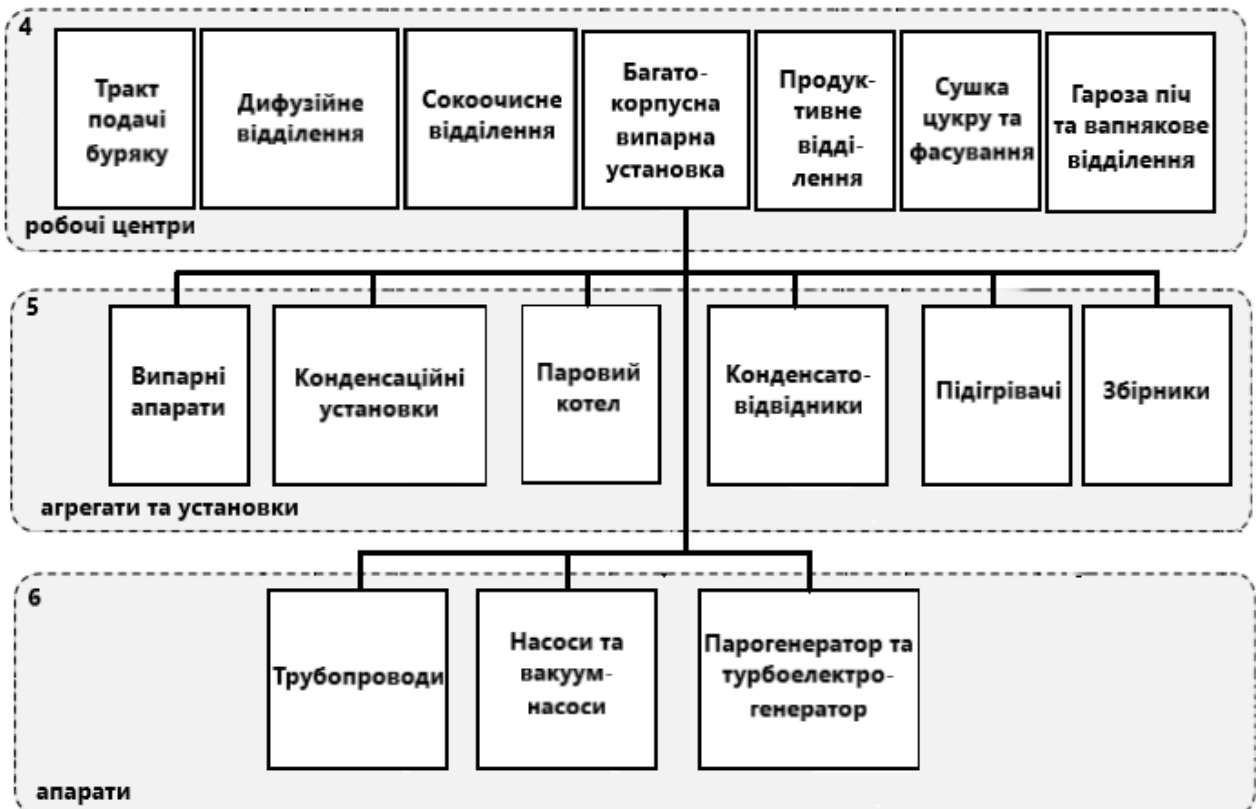
Рис. 2.8 Нижні рівні (4-6) ієрархічної моделі обладнання лінії виробництва цукру відповідно до ISA-95/106
