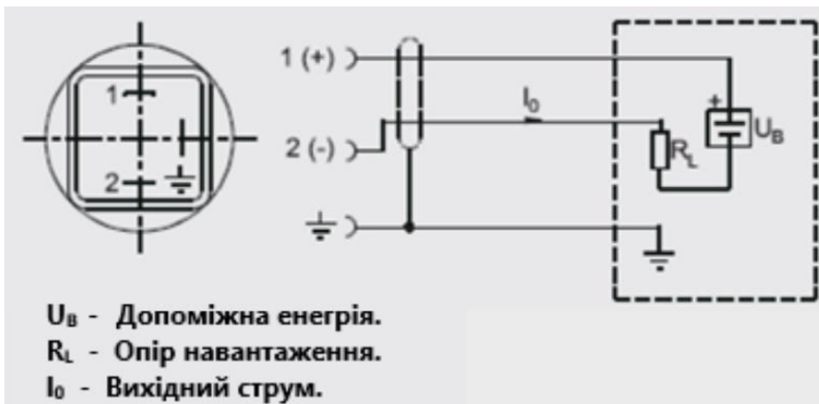
Рис.3.4. Схема підключення SITRANS TF2 до двопровідної лінії живлення
