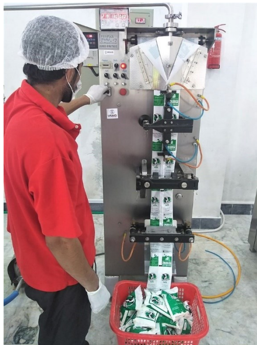
Рис. 1.4. Vertical Form Fill Seal
