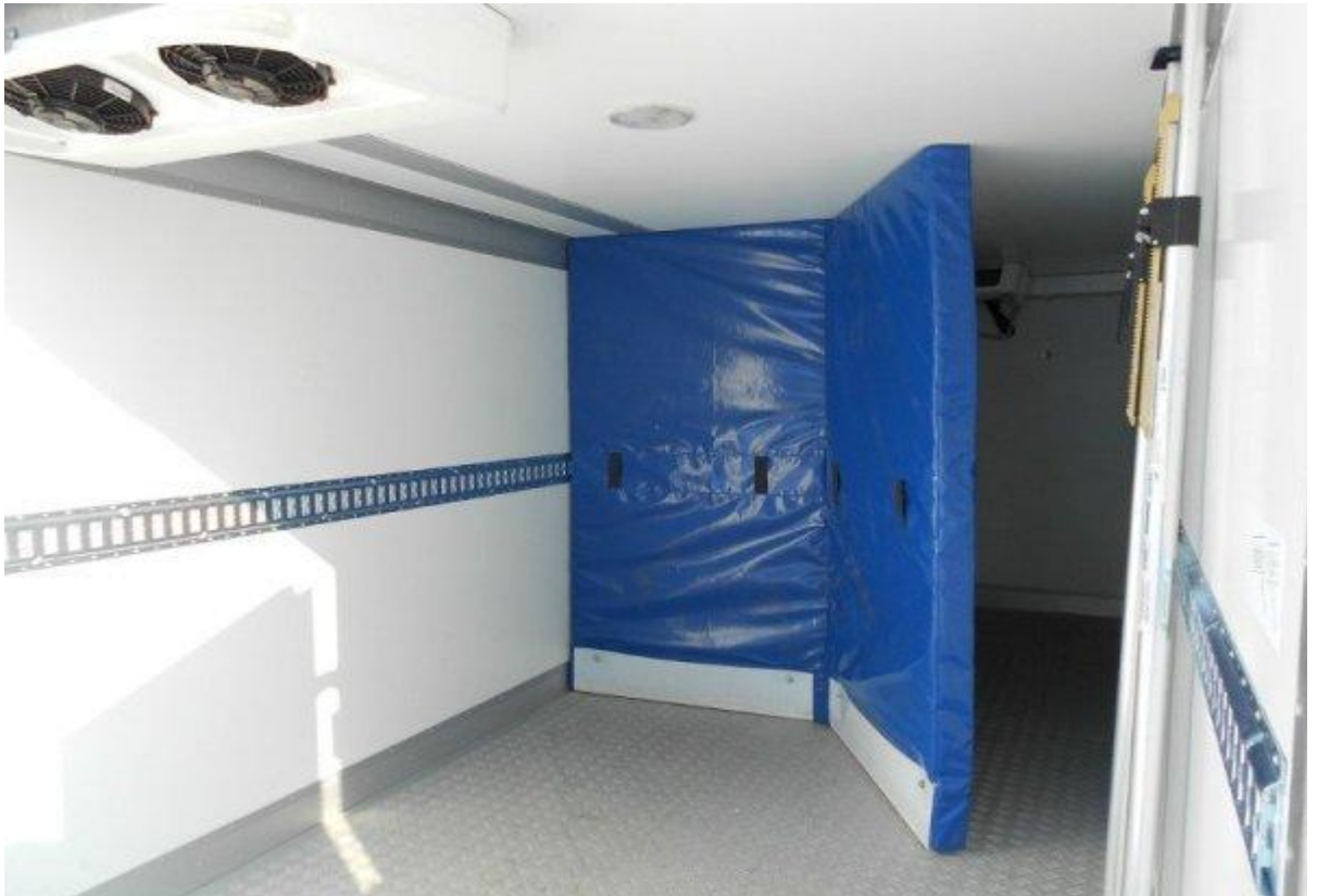
Рис.3.1.Термоізоляційна перегородка у кузові рефрижератора
