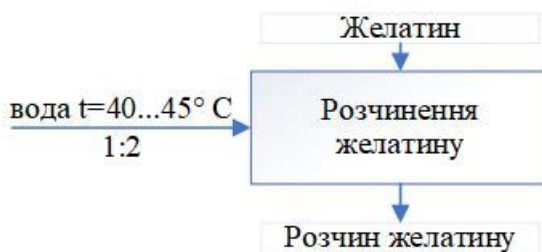
Рис. 3.5 – Схема приготування розчину желатину
