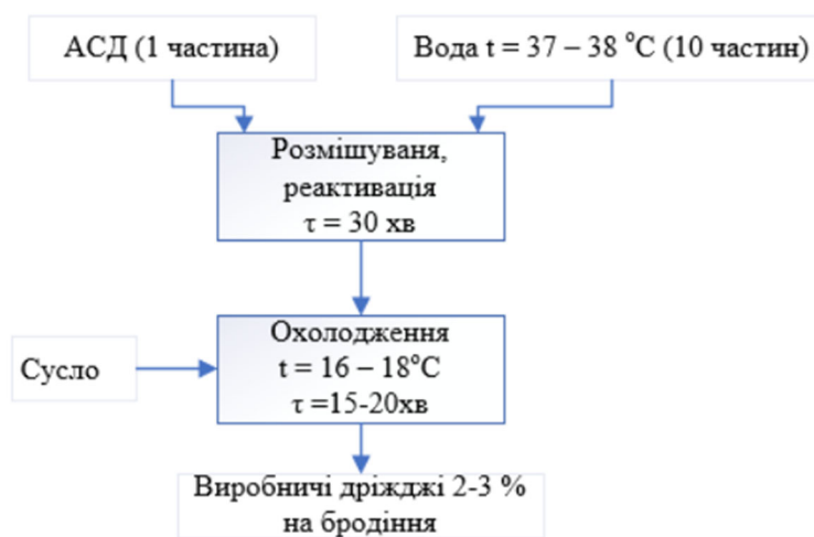
Рис. 3.4 – Схема приготування виробничих дріжджів (АСД)
