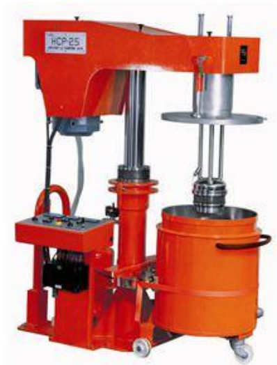
Рисунок 1.1 Занурювальний бісерний млин ( https://tecsa.com.ua/uk/obladnannya-dlya-vyrobnyctva-lfm-i-sbs/mlyny/ )
