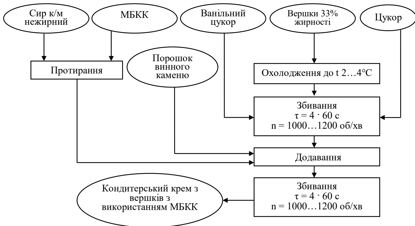
Рис. 2.11. Технологічна схема приготування кондитерського крему з вершків з використанням МБКК
