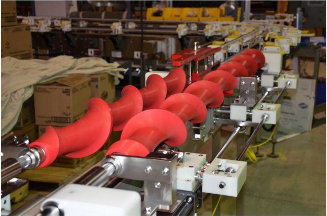
Рис. 3.7. модуль транспортної системи Septimatech із подвійними шнековими конвеєрами з горизонтальним регулюванням
