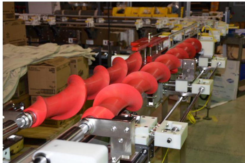
рис 4 модуль транспортної системи Septimatech із подвійними шнековими конвеєрами з горизонтальним регулюванням
