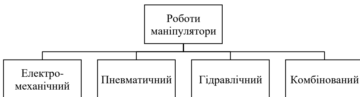
Рис.2.4. Класифікація РМ за типом силового приводу
