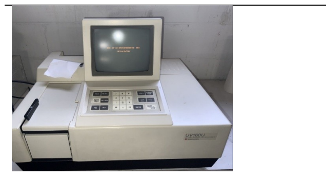
Рис. 8.3. Спектрофотометр Shimadzu UV160U УФ-видимого спектру [73]
