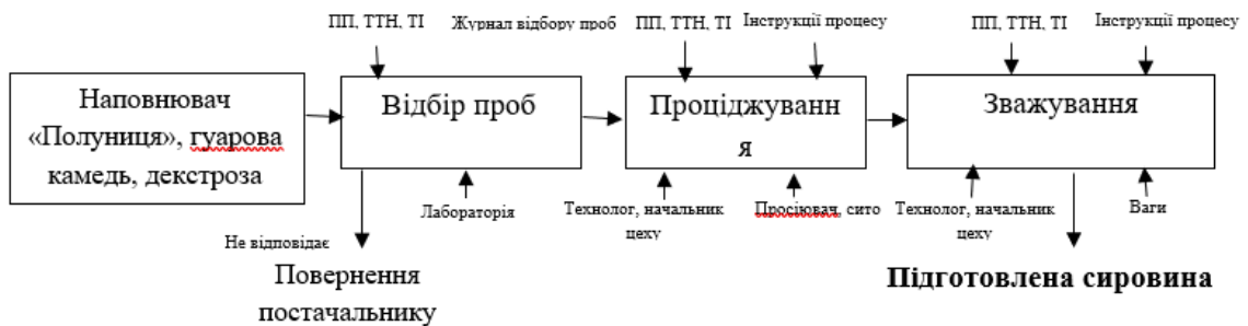
Рисунок 7.3. Структурно-функціональна схема приймання та підготовки допоміжної сировини
