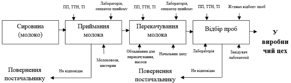
Рисунок 7.1. Структурно – функціональна схема приймання молока-сировини
