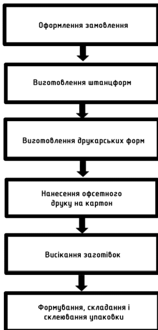
Рис.4.1. Технологічна схема виготовлення упаковки
