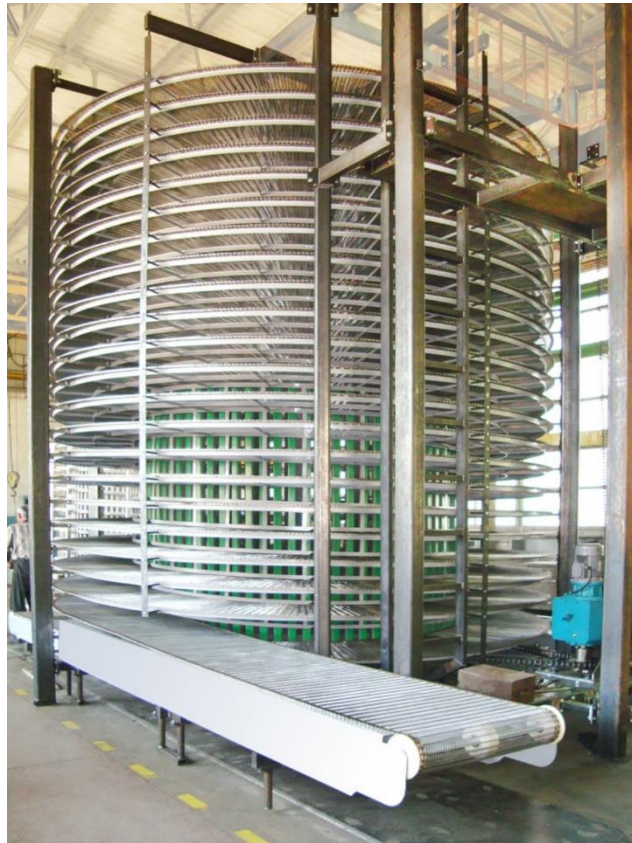
Рис. 1.6. Спіральний кулер для охолодження
