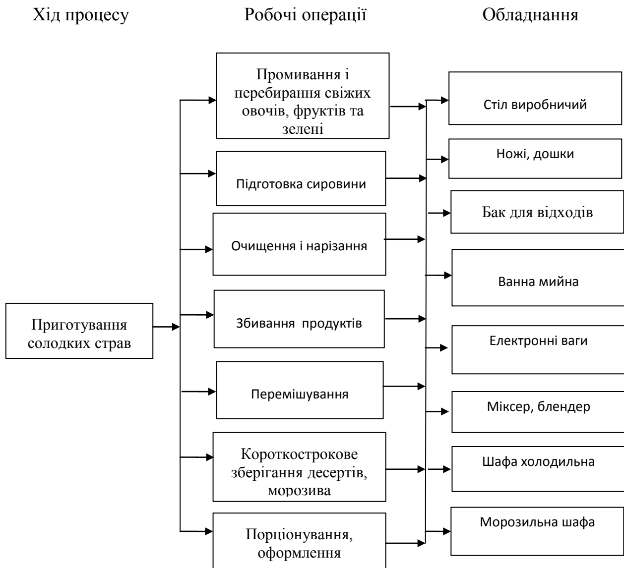
Рис. 3.5 – Структурно-технологічна схема виробничого процесу в холодному цеху
