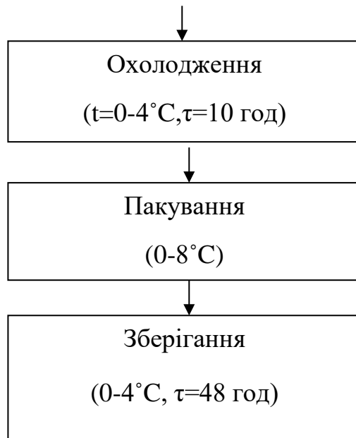
Рис.4.1. Технологічна схема виготовлення паштетів.
