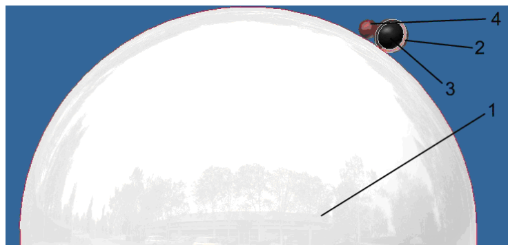
Рис. 2. 3D-модель теплообміну між паровою бульбашкою, що одночасно контактує з більшою і меншою комірками міжкристального розчину сахарози (1-парова бульбашка; 2-міжкристальний розчин сахарози меншої комірки; 3-кристал сахарози; 4- міжкристальний розчин сахарози більшої комірки)
