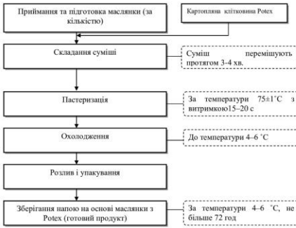
Рисунок 5 – Технологічна схема виробництва напоїв на основі з Rotex
