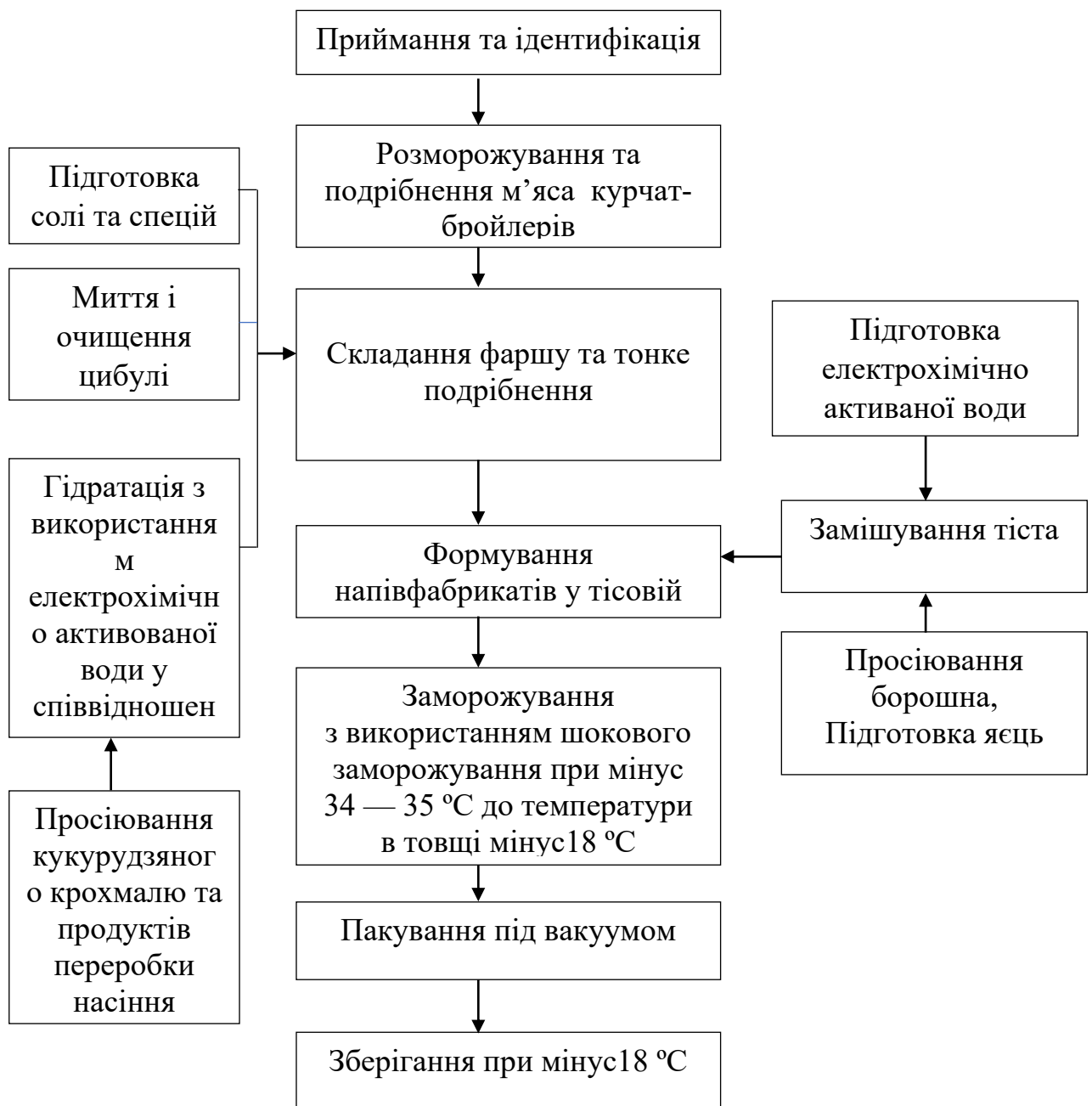
Рисунок 5.3 – Технологічна схема виробництва напівфабрикатів у тісовій оболонці з використанням продуктів переробки насіння конопель, кукурудзяного крохмалю та електрохімічно активованої води
