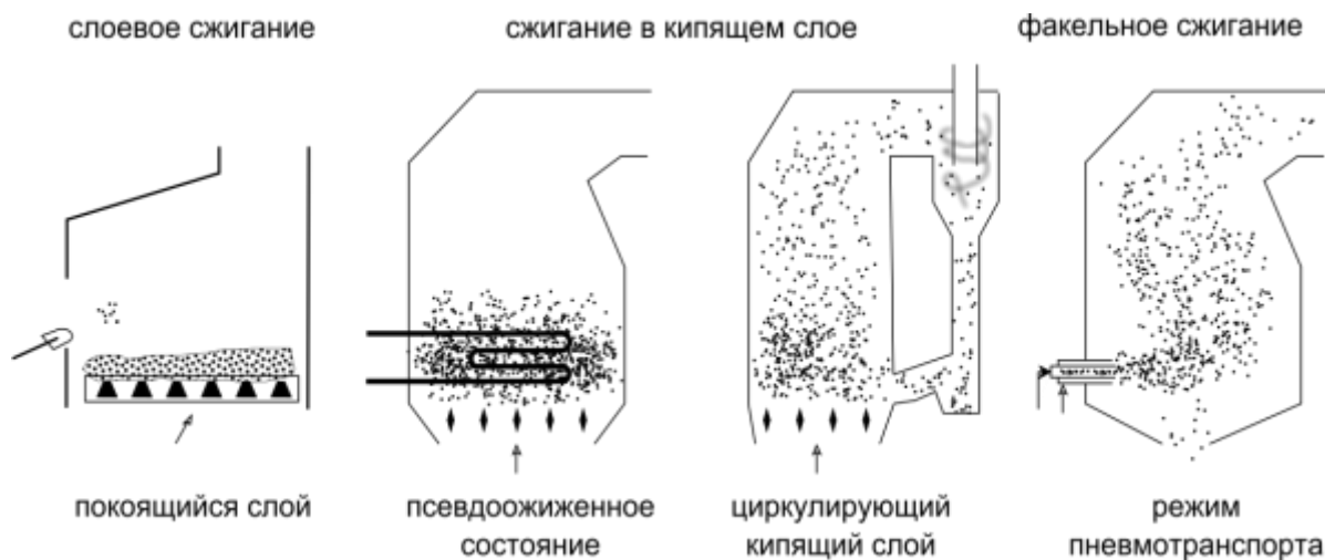
Рис. 1.6 Спалювання у киплячому шарі
