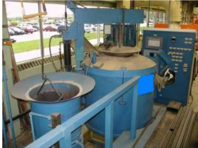
Рис. 2.3 Пристрій зони киплячого шару
