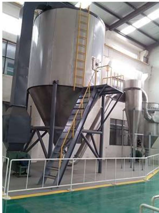
Рис. 2.8 Відцентрова розпилювальна сушарка
