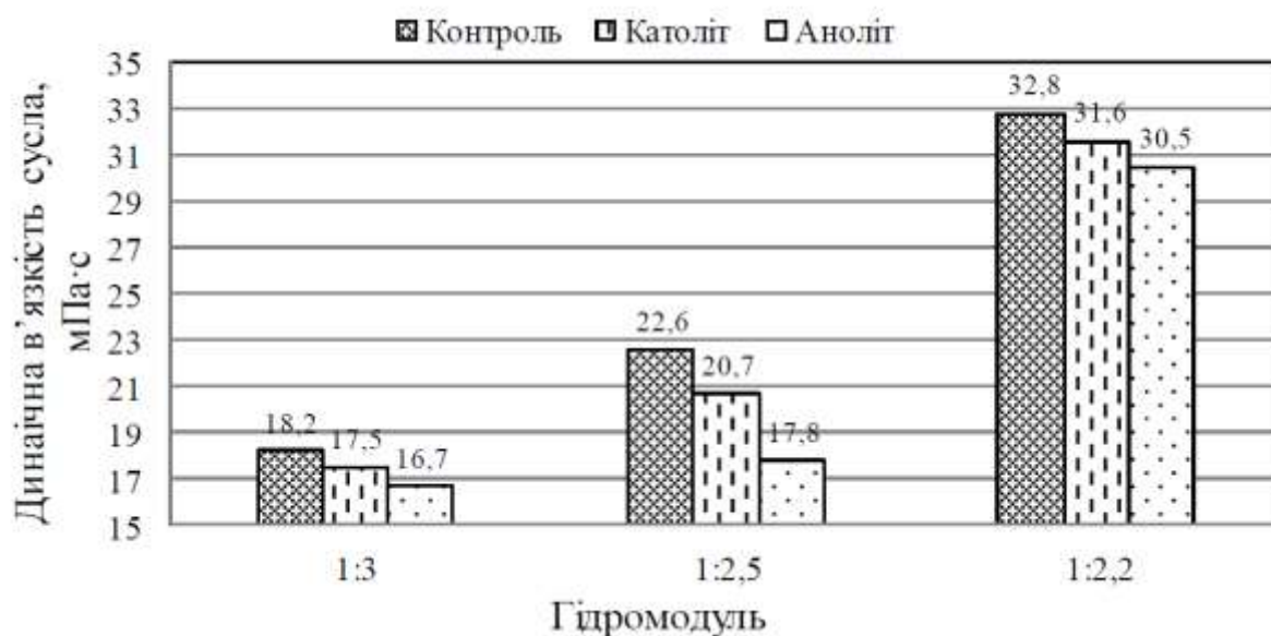
Рисунок 3.2 – Динамічна в'язкість спельтового сусла, приготованого на основі католіту, аноліту та водопровідної води (контроль)
