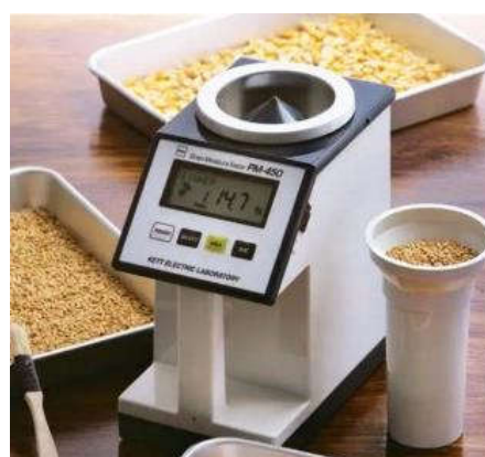
Рис. 2.2. Прилади для визначення вологості зерна кукурудзи у лабораторних умовах: а – шафа СЕШ; б – РМ-450
