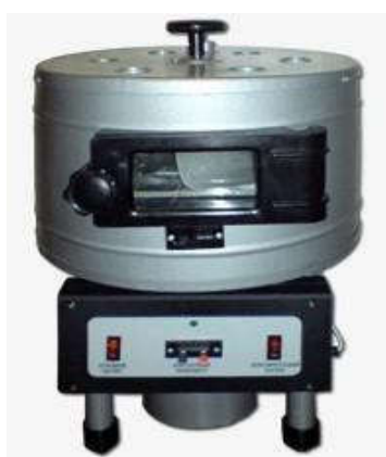
Рис. 2.2. Прилади для визначення вологості зерна кукурудзи у лабораторних умовах: а – шафа СЕШ; б – РМ-450
