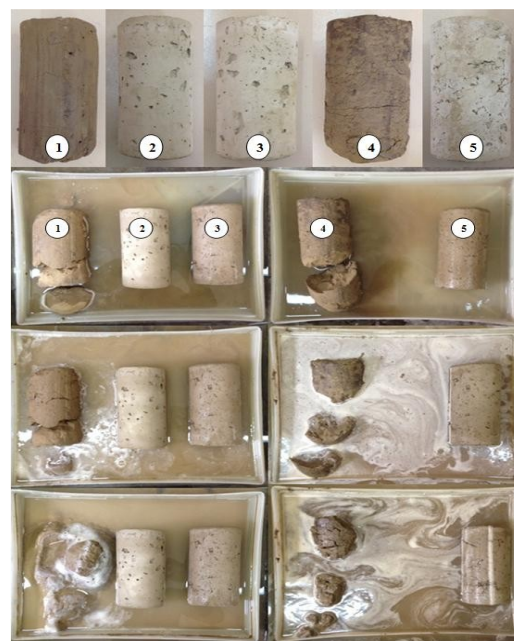
Рис. 2. Водостійкість зразків звичайних і хімічно закріплених ґрунтів:
