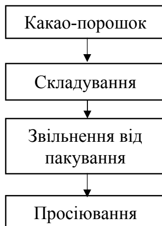
Рис.2.7.Схема підготовка какао-порошку
