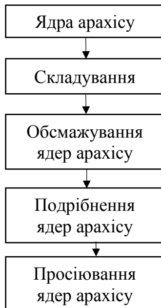
Рис.2.6.Схема підготовка ядер арахісу
