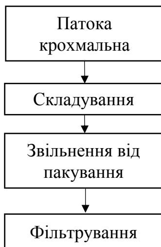
Рис.2.10.Схема підготовка патоки крохмальної
