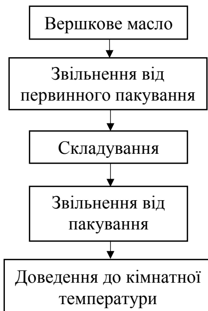
Рис.2.2.Схема підготовка вершкового масла
