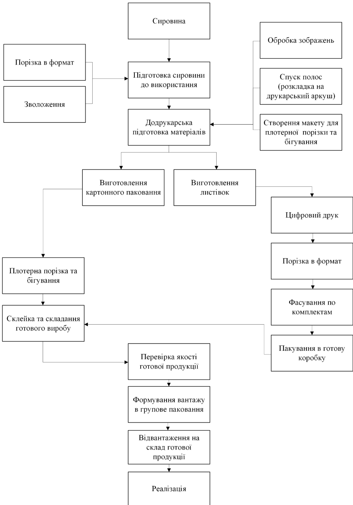
Рис. 4.1 Блок-схема процесу виготовлення пакування
