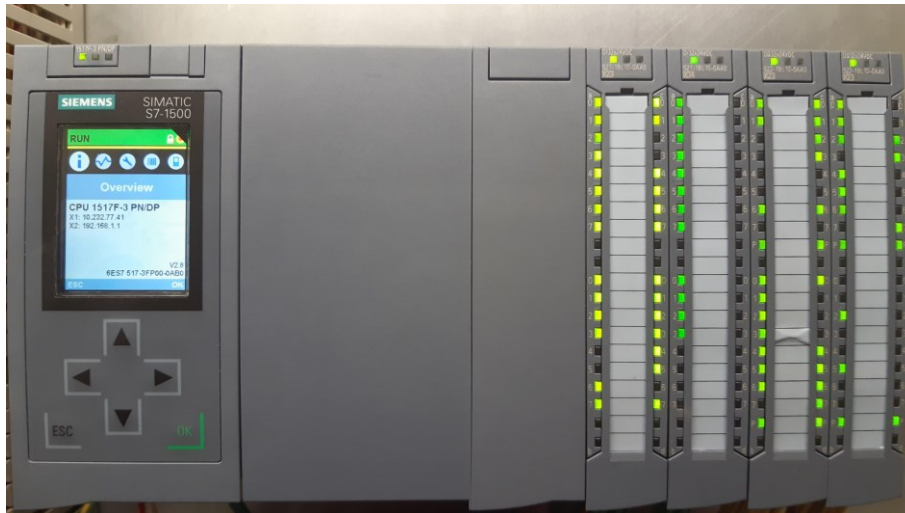
Рис. 4.4. Промисловий контролер Siemens SIMATIC S7-1500 як апаратна основа системи керування пресом
