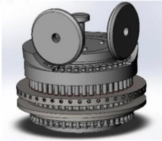
Рис. 5.1. Роторний вузол таблеткового пресу
