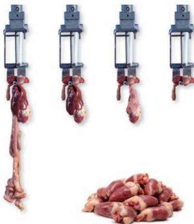
Рис. 2. Підвіска конвеєра для отримання потрухів
