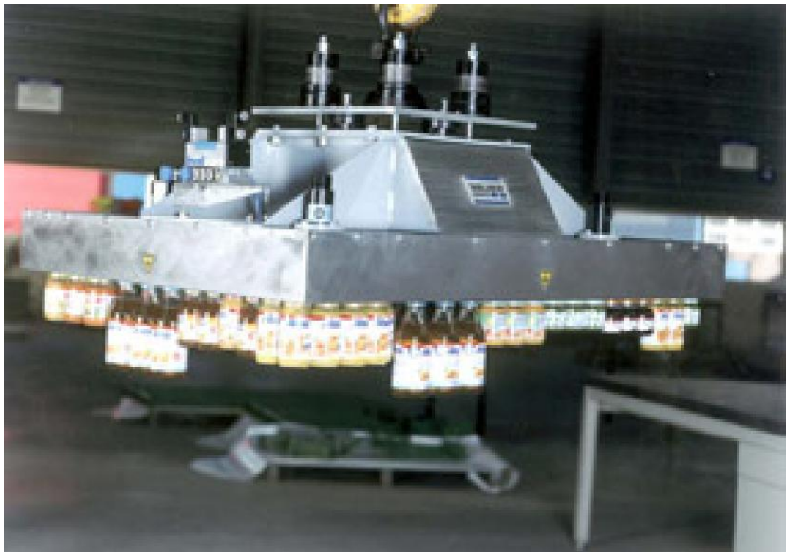
Рис.10. Магніт для палетизації скляних посудин зі сталевими кришками.
