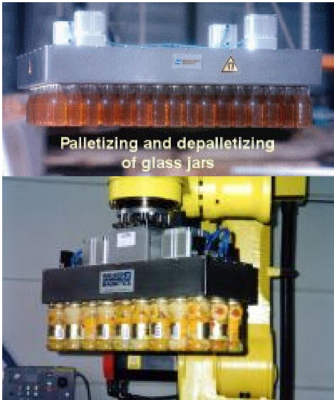
Рис. 9. Магніт для палетизації / депалетизації скляних пляшок зі сталевими кришками.
