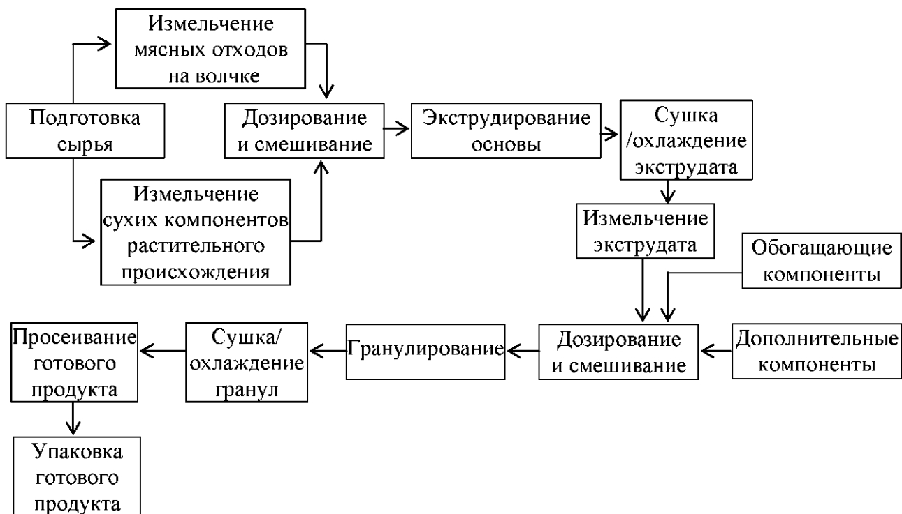
Рис. 1 — Основные стадии производства полнорационного экструдированного сухого корма для собак
