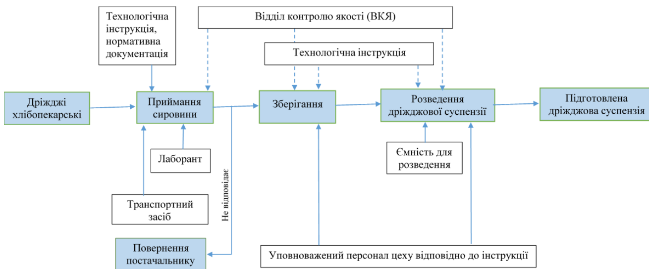
Рис. 7.4. Структурно-функціональна схема приготування дріжджової суспензії
