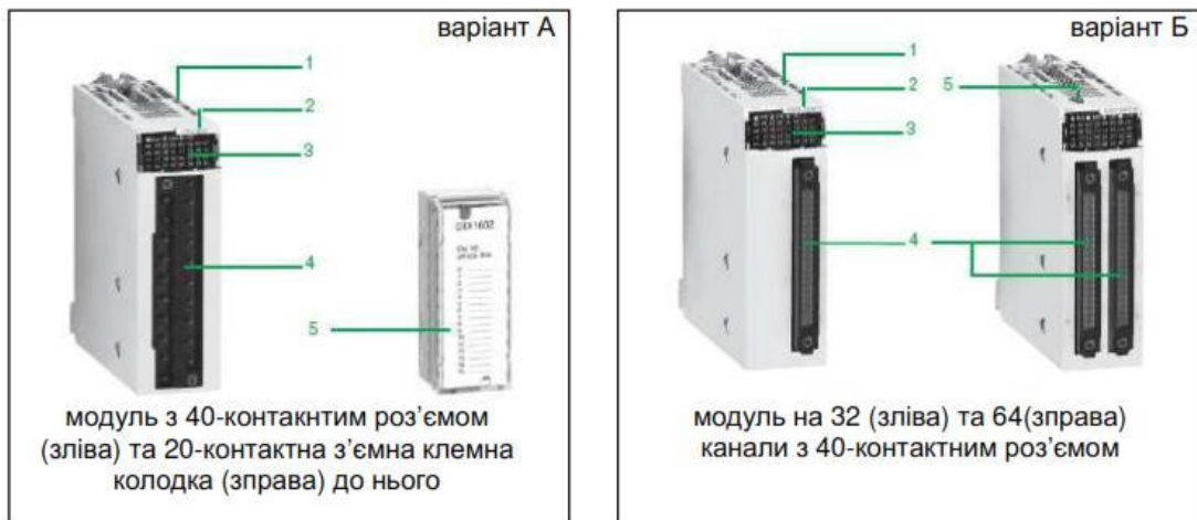
Рис.2.11. Можливі варіанти підключення дискретних модулів Загальна характеристика аналогових модулів
