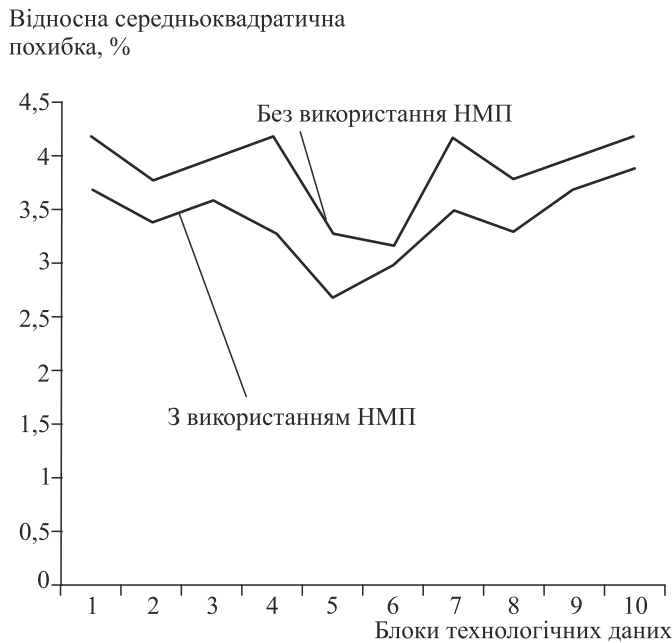
Рис. 6. Порівняння якості функціонування нейромережі з навчальними вибірками, сформованими нечіткою мережею Петрі та без її застосування
