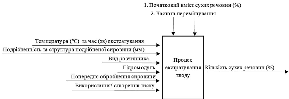
Рис. 1. Параметрична схема процесу екстрагування з визначеними збурювальними та вихідними параметрами процесу
