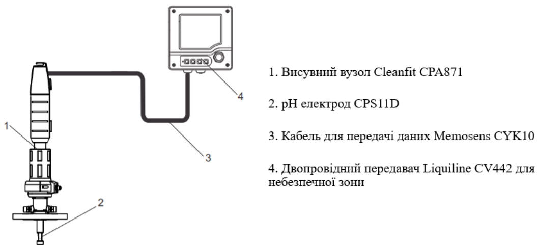
Рис. 3.3. Приклад вимірювальної системи для вимірювання pH
