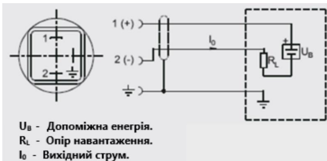
Рис. 3.14. Схема підключення SITRANS TF2 до двопровідної лінії живлення
