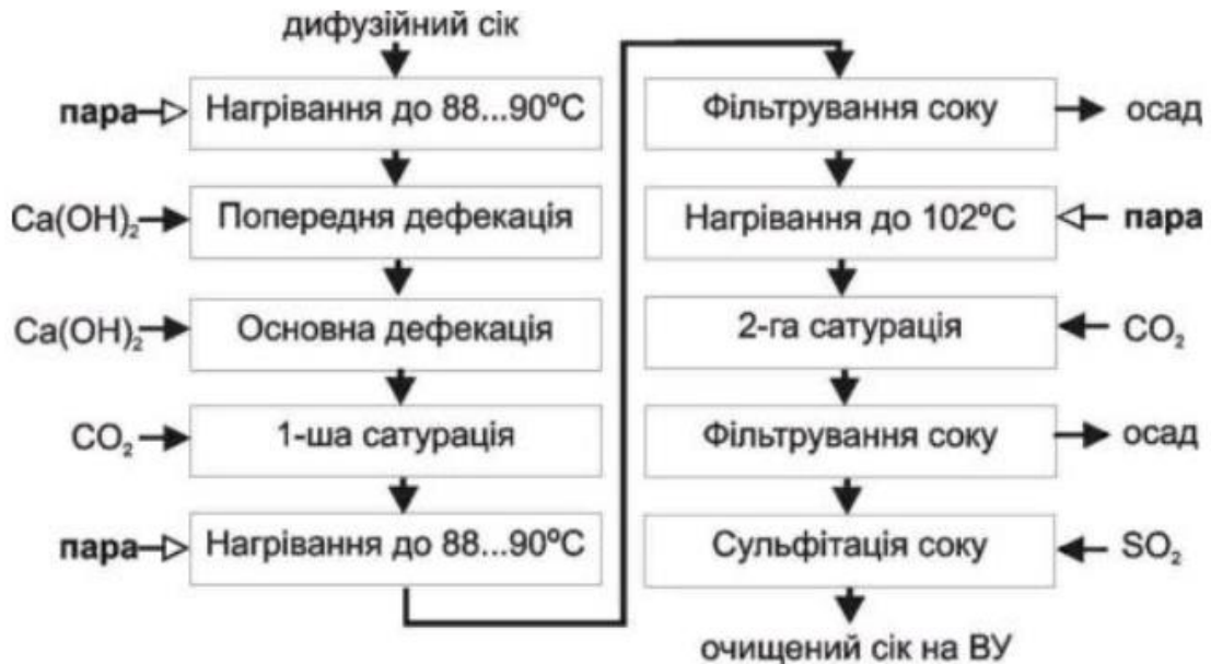
Рис. 2.1 Схема очищення дифузійного соку
