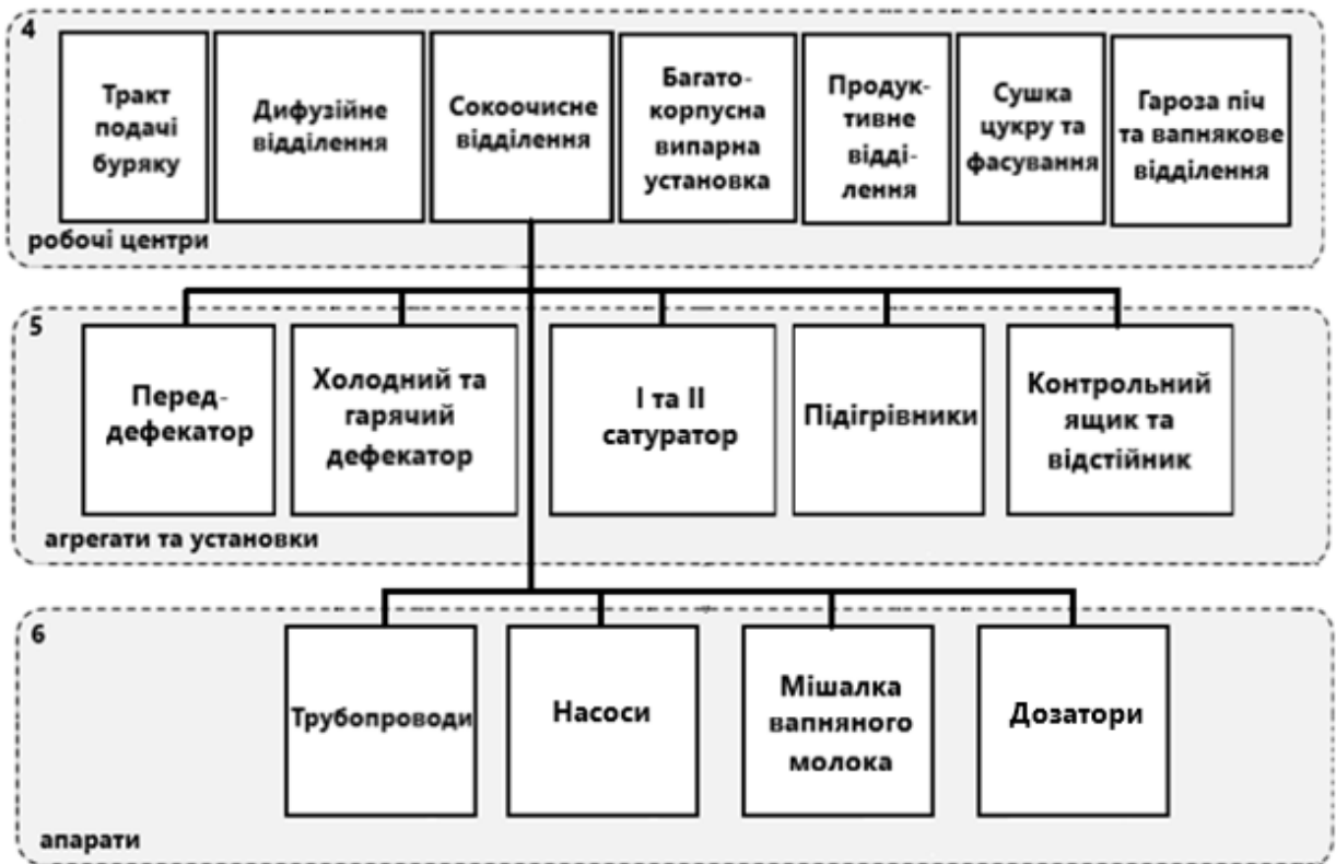
Рис. 2.7 Нижні рівні (4-6) ієрархічної моделі обладнання лінії виробництва цукру відповідно до ISA-95/106
