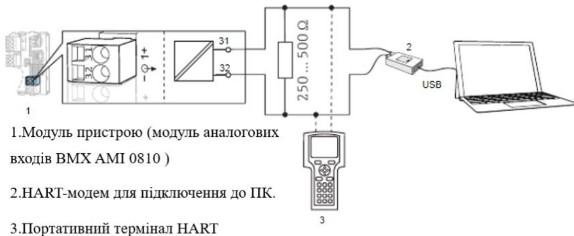
Рис. 3.5. Підключення через HART протокол
