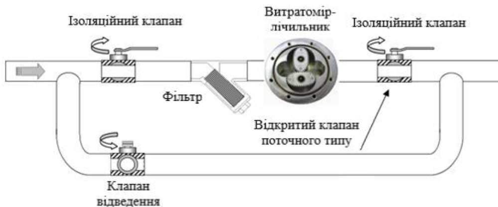
Рис. 3.8. Приклад експлуатації витратоміра-лічильника Kobold DOM
