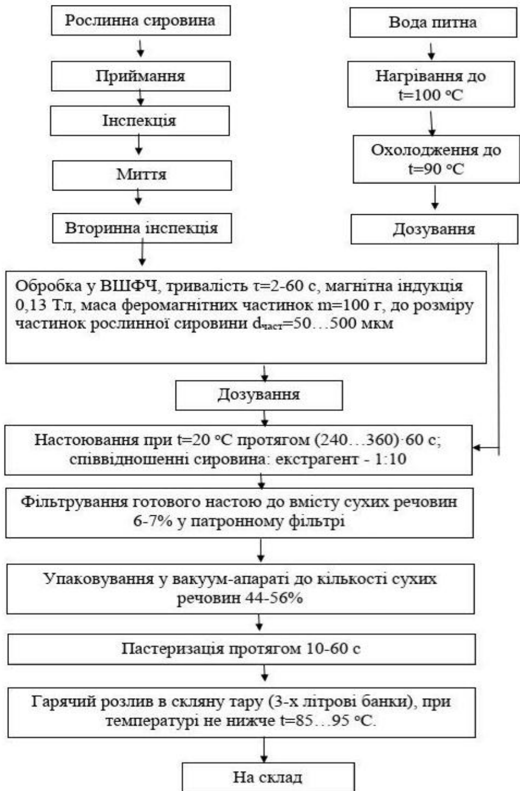
Рис. 2.1. Принципова схема технологічного процесу одержання рослинних екстрактів
