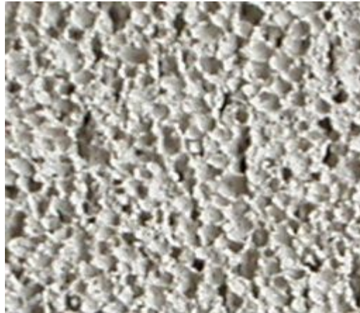
Рис. 2. Макроструктура теплоізоляційного газобетону автоклавного твердіння ( \rho = 150 \text{ кг/м}^3 ).
