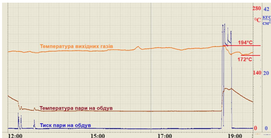
Рис. 4. Графік температури вихідних газів та вплив обдувки поверхонь нагріву на процес теплопередачі
