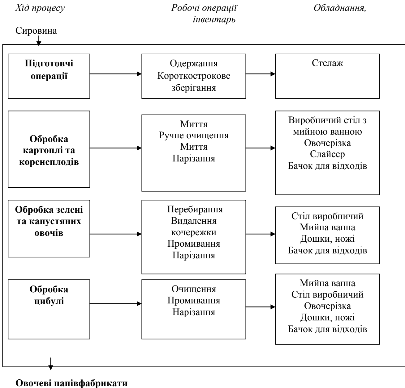
Рис. 3.4. Структурно-технологічна схема овочевого цеху
