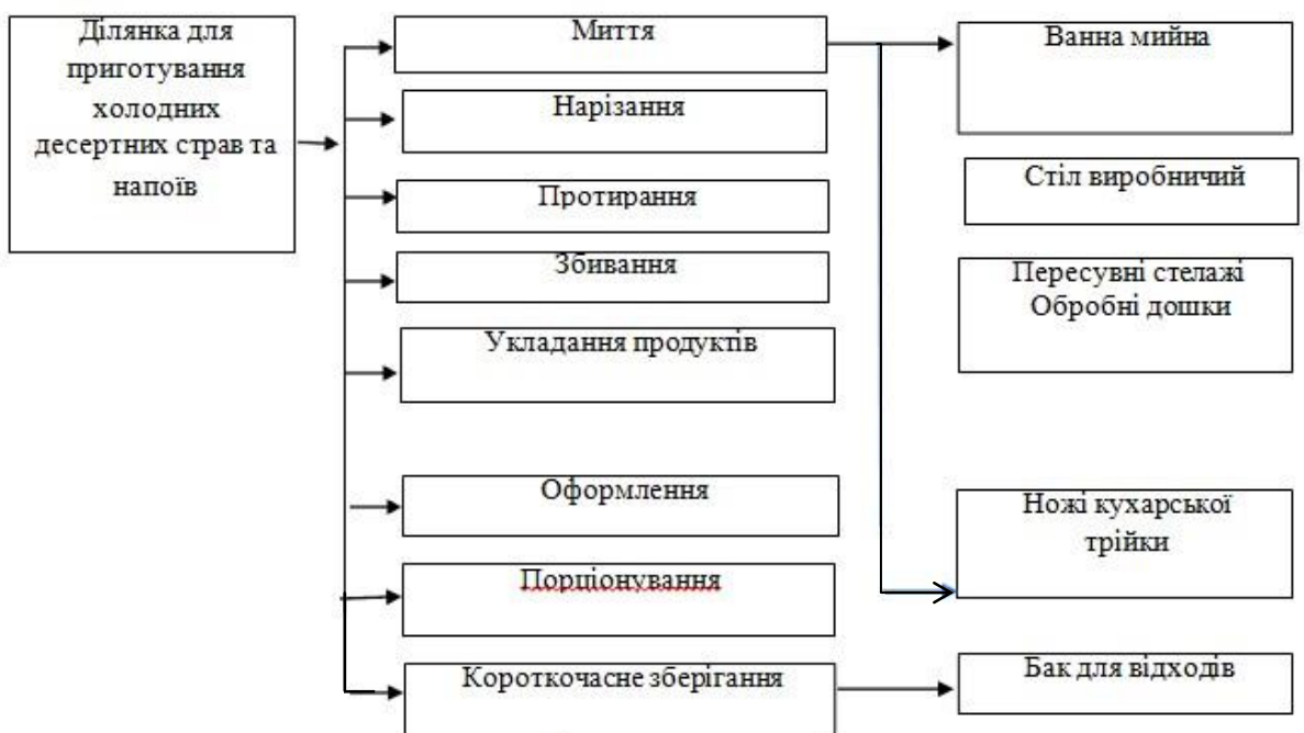
Рис 3.4 – Структурно- технологічна схема виробничого процесу холодного цеху
