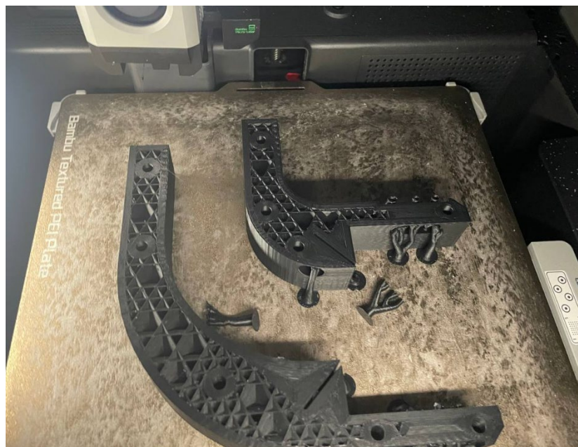
Рисунок 48. Поворотний вузол під час друку.
