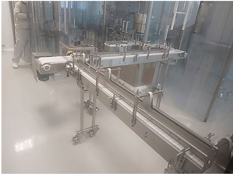
Рисунок 7. – Кутова транспортерна лінія компанії «Altan Mekatronik OOD»
