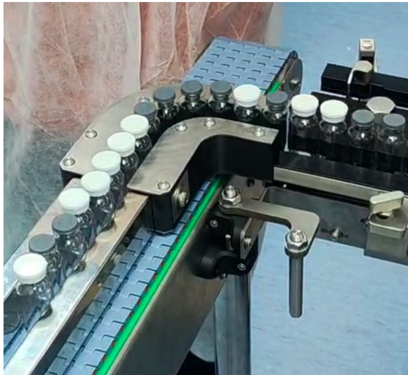
Рисунок 47. Встановлений поворотний вузол під час тестів.
