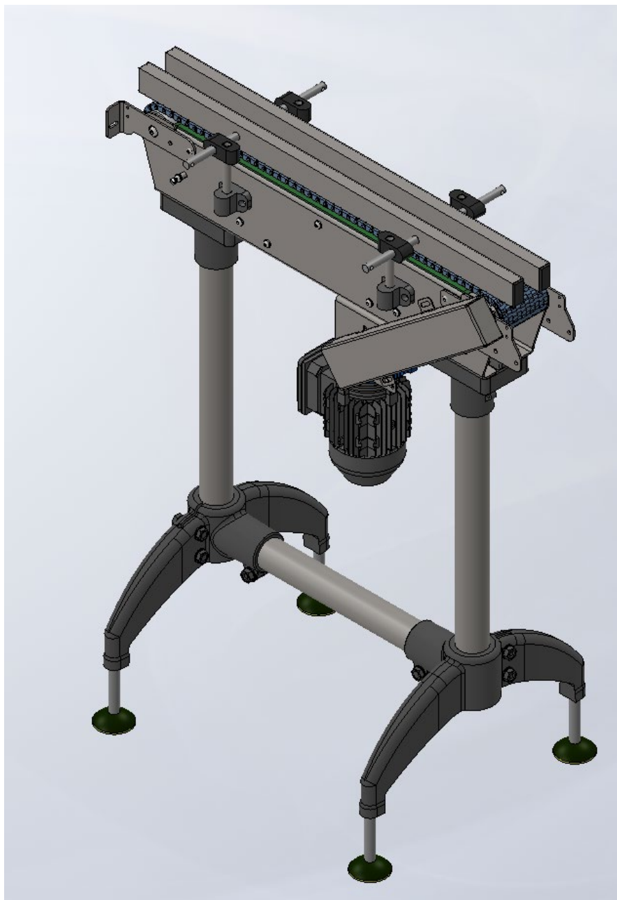
Рисунок 28. Конвеєр габаритною довжиною 700 мм.
