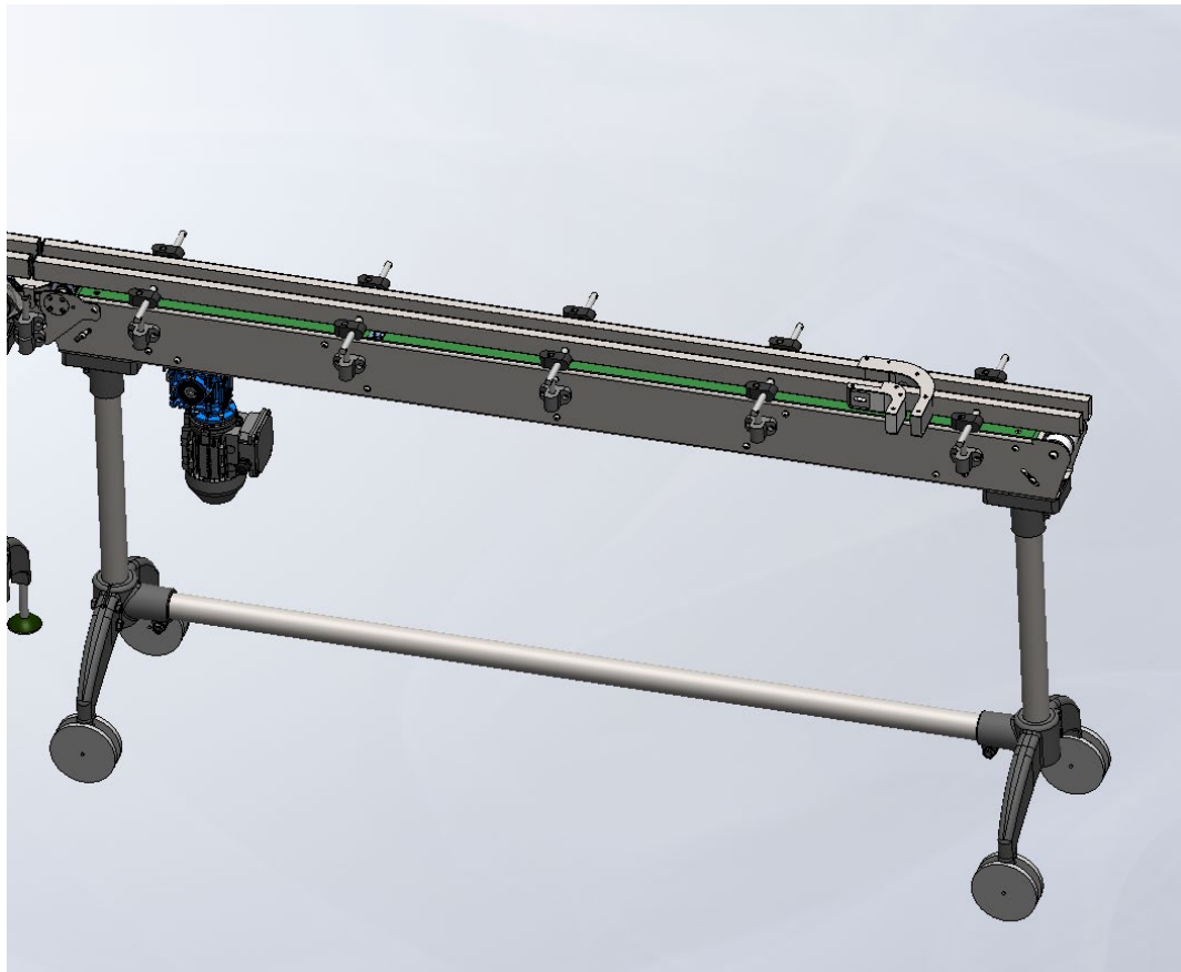
Рисунок 27. Конвеєр з колесами вмонтованими в ніжки
