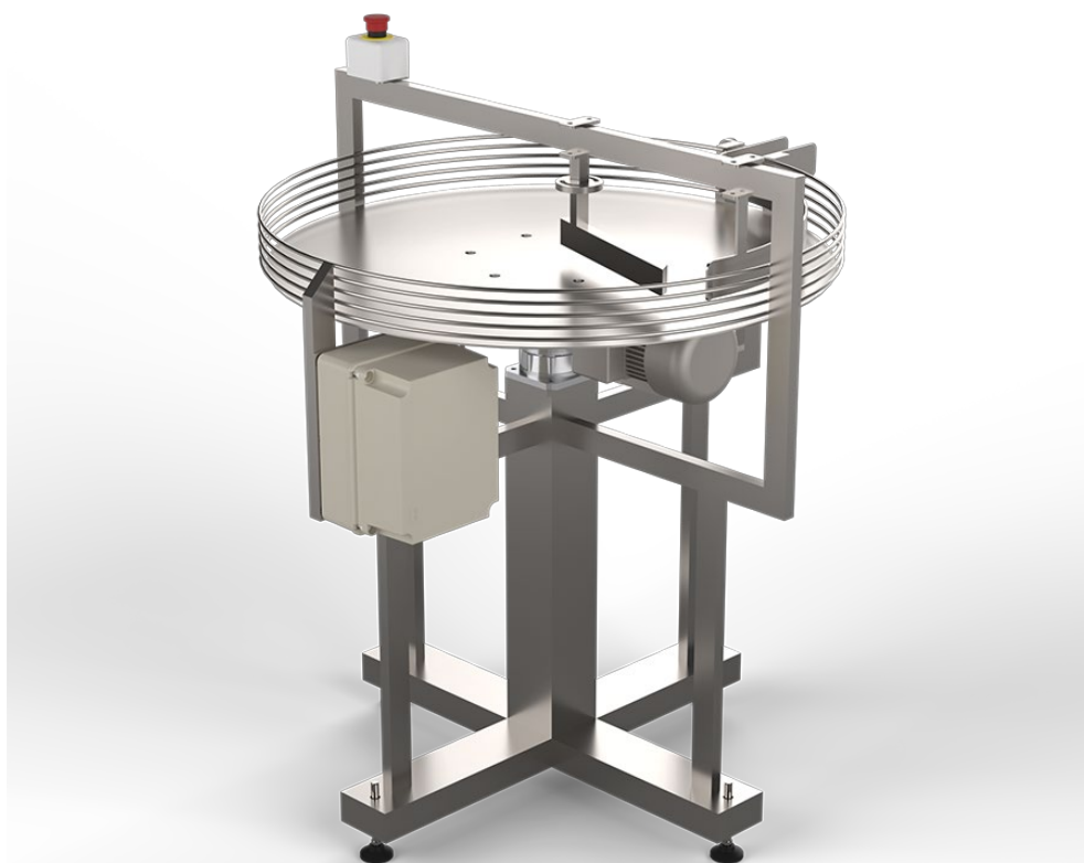
Рисунок 9. – Ізометричний вид на ротаційний стіл.
