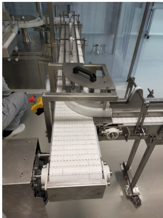
Рисунок 8. – Поворотний вузол кутової транспортерної лінії компанії «Altan Mekatronik OOD»
