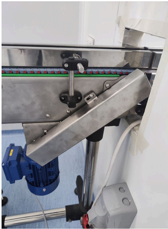
Рисунок 36. Зовнішній вигляд захисного кожуха пасової передачі
