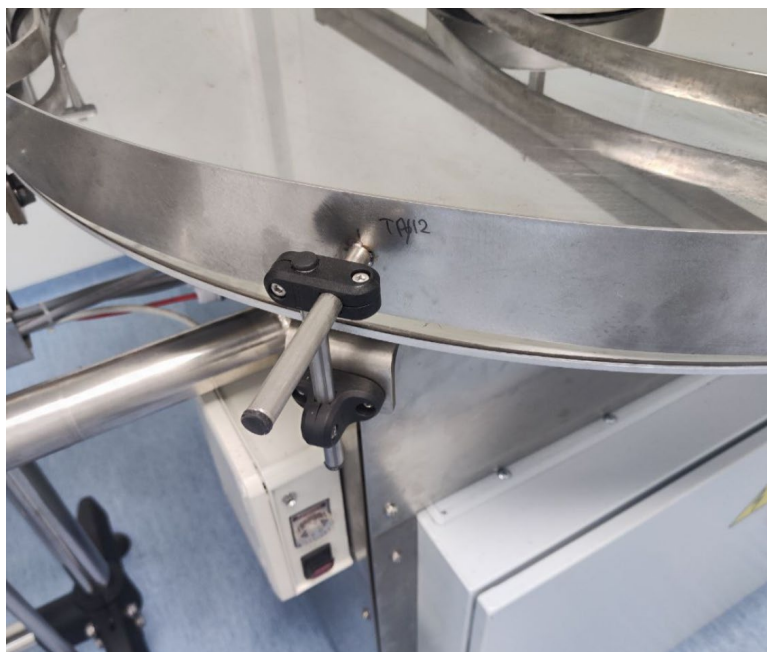
Рисунок 63. Приварені трубки для заміни гвинтових з'єднань
