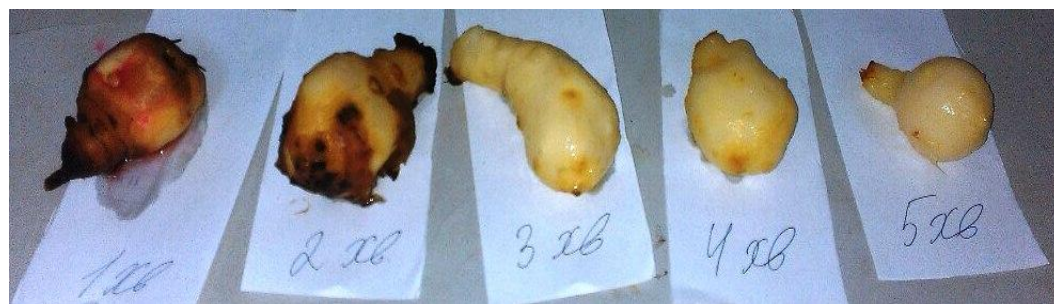
Рис.1 Результаты очистки клубней топинамбура 4% раствор щелочи NaOH, мин.
