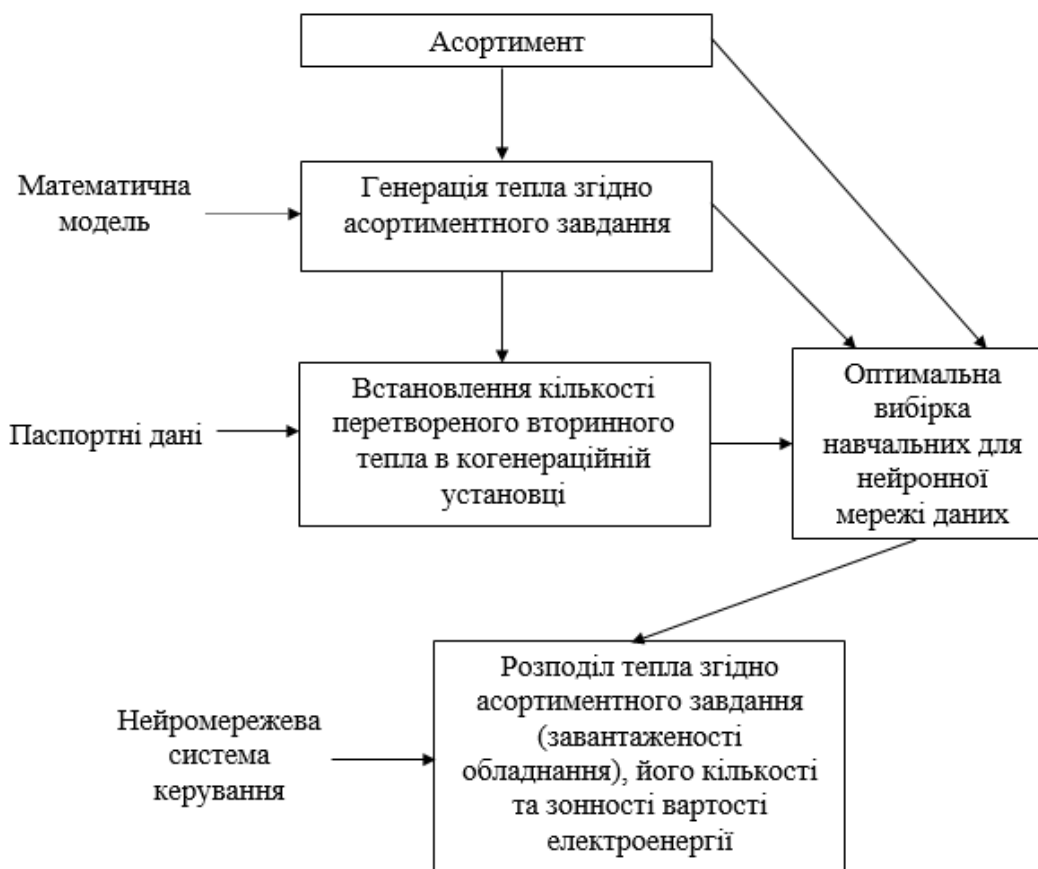
Рис. 1. Узагальнена структура енергоефективного управління процесом випічки хліба
