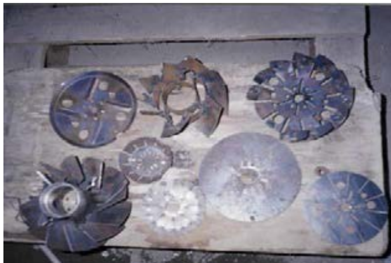
Рис. 2.15. Металеві завихрювачі, що використовує фірма DAVA
