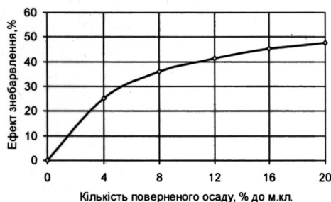
Рис. 1. Залежність ефекту знебарвлення клеровки тростинного цукру-сирцю від витрат вапна — carbonізаційного осаду
