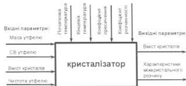
Рис. 1. Процес кристалізації сахарози охолодженням в кристалізаторах як об'єкт технології.
