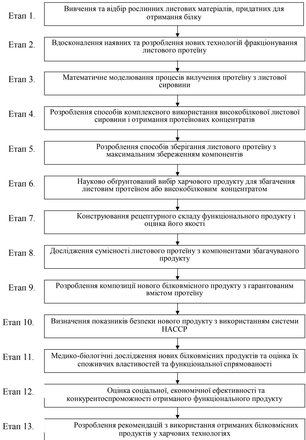
Рис. 2. Етапи отримання білкових концентратів із зеленої маси рослин та функціональних продуктів на їхній основі
